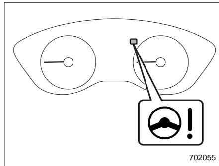
При переводе замка зажигания в положение “ON” на комбинации приборов загорается предупреждающая лампа усилителя рулевого управления, информируя водителя об исправной работе системы предупреждения. Затем, после запуска двигателя, предупреждающая лампа гаснет, информируя водителя о нормальной работе усилителя рулевого управления.
