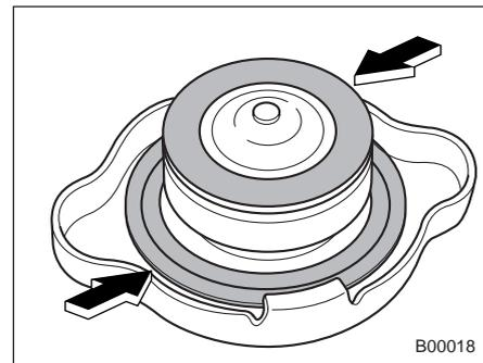
4. После доливки охлаждающей жидкости в расширительный бачок и радиатор установите на них крышки, предварительно убедившись в правильности положения резиновых уплотнений крышки радиатора.
