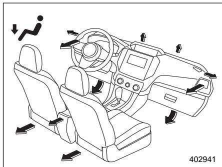
**Обогрев:** основная подача воздуха через вентиляционные отверстия обдува ног, боковые вентиляционные отверстия в панели приборов и слабая — через вентиляционные отверстия обогрева ветрового стекла (слабый поток воздуха подается на ветровое стекло и боковые стекла для предотвращения их запотевания).
