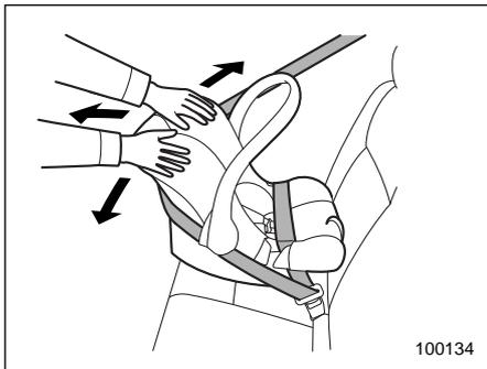
5. Проверьте надежность фиксации детского удерживающего устройства, подвигав его вперед/назад и из стороны в сторону.
