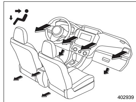
**Вентиляция 2 для типа "В":** вентиляционные отверстия панели приборов и вентиляционные отверстия обдува ног.
