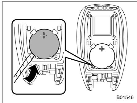
3. Извлеките элемент питания при помощи плоской отвертки, обернутой виниловой лентой или тканью.
