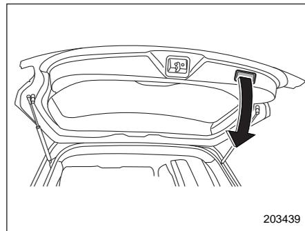
Плавно опустите дверцу багажного отсека, а затем с усилием прижмите ее книзу до срабатывания защелки.
