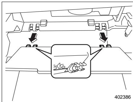
(4) Извлеките отделение для перчаток горизонтально и снимите петли. При выполнении этой операции будьте осторожны, чтобы не повредить петли.
