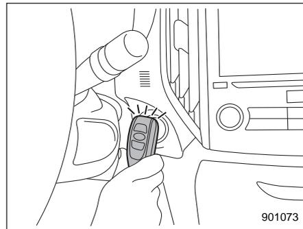
4. Удерживая брелок дистанционного доступа так, чтобы его кнопки были обращены к Вам, коснитесь им кнопки запуска/остановки двигателя. Когда процесс обмена данными между брелоком дистанционного доступа и автомобилем будет завершен, раздастся звуковой сигнал (“динь”), а индикатор режима работы на кнопке запуска/остановки двигателя загорится зеленым цветом. Одновременно кнопка запуска/оста-
