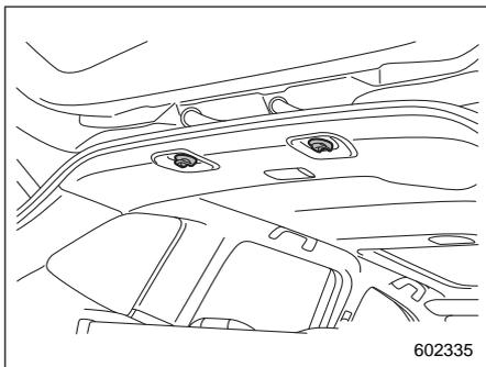
На внутренней отделке багажного отсека имеются два крючка. Используйте их для подвески или крепления легких предметов на стоящем автомобиле.
