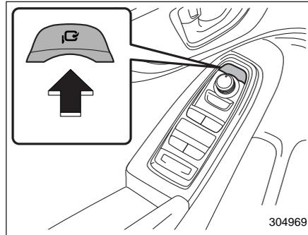
Переключатель электропривода складывания зеркал работает только тогда, когда замок зажигания находится в положении “ON” или “ACC”.
