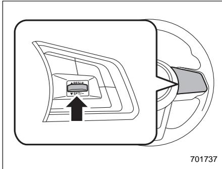
Если скорость движения Вашего автомобиля составляет около 30 км/ч или более, то для возобновления работы системы круиз-контроля после ее временного отключения нажмите на сторону "RES" переключателя "RES/SET", что приведет к автоматическому восстановлению установленной до этого постоянной скорости движения. При этом на комбинации приборов автоматически загорится контрольная лампа установки круиз-контроля.
