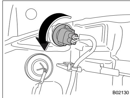
3. Отключите электрический разъем от лампы и снимите лампу с фары, повернув ее против часовой стрелки.
