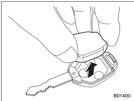
2. Снимите корпус передатчика с головки ключа.
