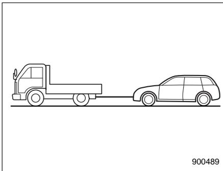
1. Снимите автомобиль со стояночного тормоза и установите трансмиссию на нейтральную передачу.
