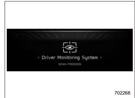
1. Когда дверь открыта и кнопкой запуска/остановки двигателя установлен режим “OFF” электропитания автомобиля, появляется экран распознавания пользователя, а система мониторинга состояния водителя начинает распознавание пользователя.
