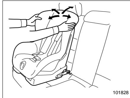
6. Перед тем как посадить ребенка в детское удерживающее устройство, проверьте надежность его фиксации, попробовав подвигать устройство вперед/назад и из стороны в сторону.
