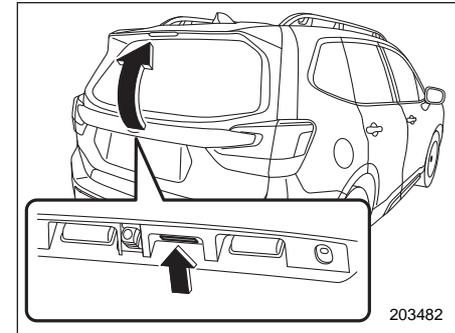
Кнопка открывания дверцы багажного отсека
