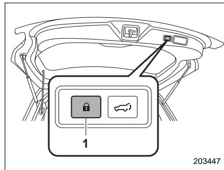
1) Кнопка запирания дверей на дверце багажного отсека с электроприводом.
