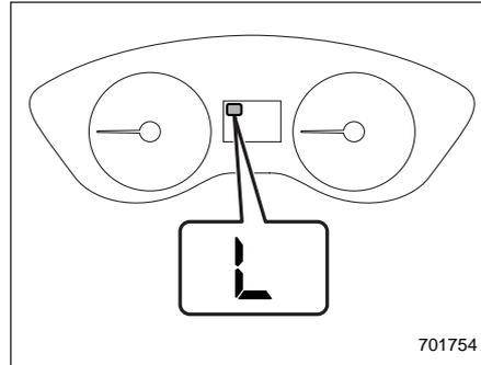
При выборе режима на комбинации приборов включается индикатор “L”.
