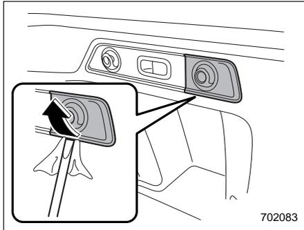
1. При помощи плоской отвертки снимите технологический лючок с правой стороны внутренней отделки багажного отсека.
