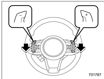
Для переключения вверх на следующую, более высокую передачу, потяните подрулевой переключатель передачи, обозначенный “+”. Для переключе-
