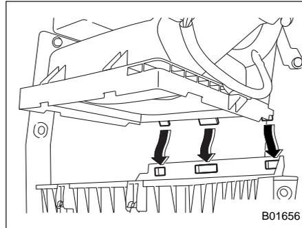
5. Чтобы установить заднюю часть корпуса воздушного фильтра, вставьте три выступа на задней части корпуса воздушного фильтра в пазы на передней части корпуса воздушного фильтра.
