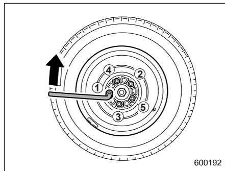
15. Надежно затяните гайки крепления колеса баллонным ключом с предусмотренным моментом затяжки. При этом соблюдайте последовательность затяжки, показанную на рисунке.
