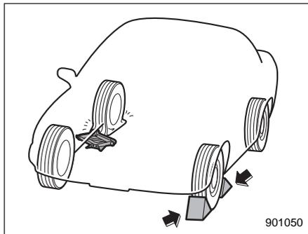
4. Установите тормозные башмаки спереди и сзади под колесо, диагонально противоположное спущенному колесу.
