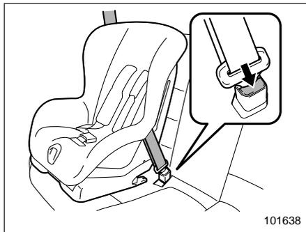
12. Чтобы снять детское удерживающее устройство, нажмите кнопку фиксатора на пряжке ремня безопасности и дайте ремню полностью втянуться. После этого натяжитель ремня безопасности будет переведен обратно в режим аварийной блокировки.
