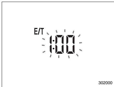
Индикатор длительности поездки мигает по истечении каждого целого часа. Если на дисплей выдаются другие показания вместо длительности поездки, то дисплей переключается на длительность поездки, мигает в течение 5 секунд и возвращается к изначальным показаниям по истечении каждого целого часа.
