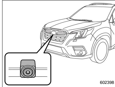
Изображение камеры, установленной внутри решетки радиатора, передается на multifunctional display (color liquid crystal display). This eliminates blind spots and allows the driver to control the front direction from both sides.
