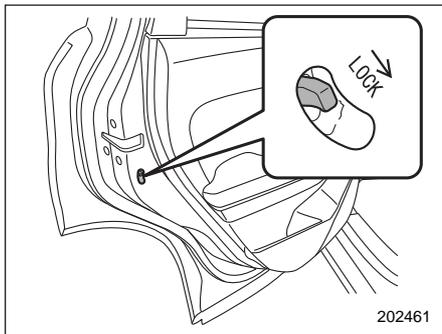
Каждая задняя дверь снабжена механизмом блокировки от детей. Если рычажок механизма блокировки дверей от детей переведен в положение “LOCK”, то дверь нельзя открыть изнутри. Эту дверь можно открыть только снаружи.
