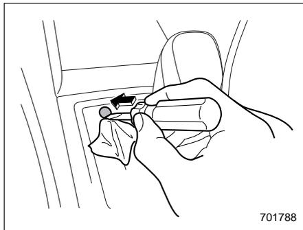
2. Оберните наконечник плоской отвертки виниловой лентой или тканью и используйте ее для снятия заглушки замка блокировки рычага селектора. Кнопка разблокировки рычага селектора находится под заглушкой замка блокировки рычага селектора.
