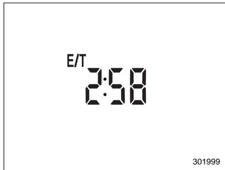
Длительность поездки отображает время, прошедшее с момента перевода замка зажигания в положение "ON".
