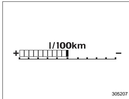
Эконометр показывает разницу между текущим расходом топлива и средним расходом топлива с момента последнего сброса показаний счетчика пройденного пути.
