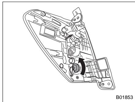
7. Извлеките патрон лампы из заднего комбинированного фонаря, поворачивая его против часовой стрелки.
