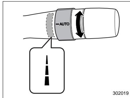
Для регулировки чувствительности датчика дождя/освещенности, управляющего стеклоочистителем, поверните кольцо. Для повышения чувствительности поверните кольцо вниз. Для понижения чувствительности поверните кольцо вверх.
