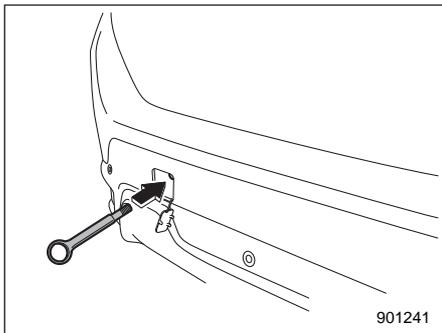
3. Вверните буксировочный крюк в резьбовое отверстие до тех пор, пока полностью не скроется резьба на буксировочном крюке.
