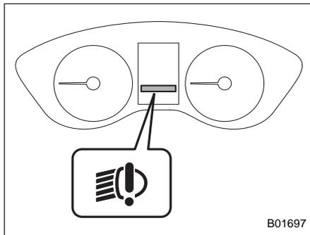
В случае неисправности светодиодных фар включается предупреждающая лампа светодиодных фар. В такой ситуации мы рекомендуем Вам при первой возможности обратиться к дилеру SUBARU для проведения работ по диагностике Вашего автомобиля.
