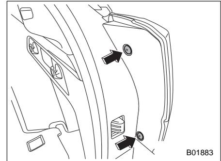
1. При помощи отвертки снимите фиксаторы крышки.
