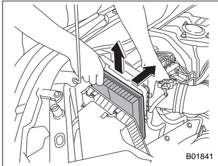
3. Снимите фильтрующий элемент воздушного фильтра.
