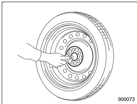
12. Перед установкой запасного колеса протрите тканью посадочное место колеса и ступицу колеса.
