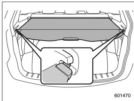
Чтобы установить выдвижную шторку, полностью вытяните ее из кожуха и зафиксируйте ее положение крючками, как показано на рисунке. Для сматыва-
