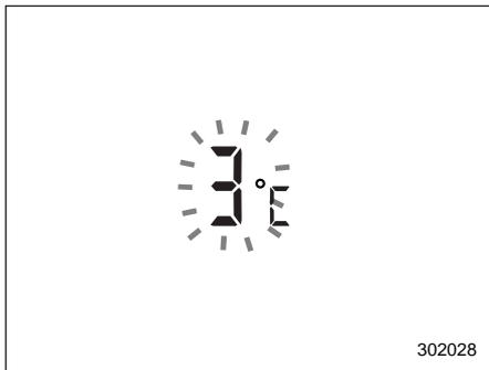
Когда температура наружного воздуха снижается до определенной температуры или ниже, показания индикатора температуры наружного воздуха начинают мигать в течение 5 секунд, указывая на то, что дорожное покрытие может быть обледенелым.
