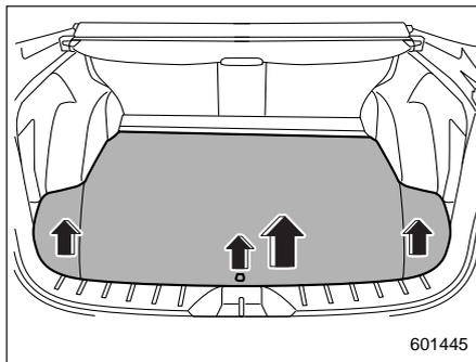
1. Потяните за ремешок, чтобы открыть центральную часть крышки пола багажного отсека, а затем снимите крышку.
