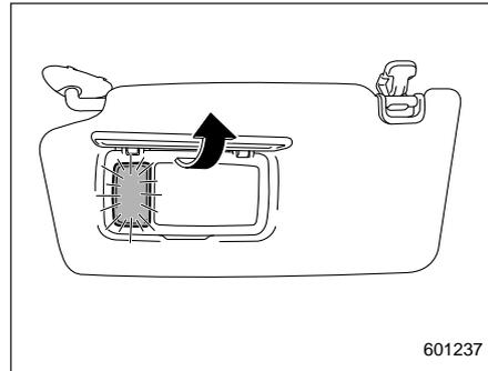
Чтобы воспользоваться зеркалом, опустите солнцезащитный козырек и поднимите крышку зеркала. Подсветка зеркала включается при открывании крышки зеркала.
