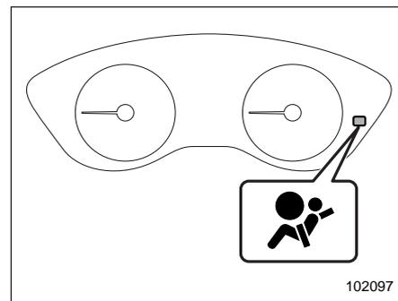
Если замок зажигания установлен в положение "ON", диагностическая система непрерывно отслеживает готовность системы подушек безопасности (включая преднатяжители ремней безопасности передних сидений). О нор-
