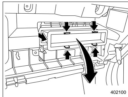
2. Снимите воздушный фильтр салона в соответствии с приведенной ниже процедурой, чтобы не допустить попадания пыли с воздушного фильтра салона внутрь его корпуса.
