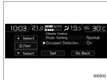
2. При помощи клавиш управления выберите вариант “Включено” или “Выключено”, чтобы включить или выключить определение посадки пассажира.
