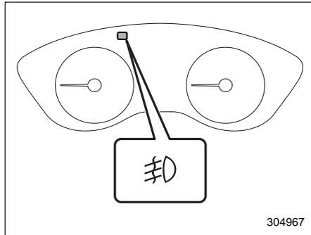
При включении противотуманных фар на комбинации приборов загорается контрольная лампа.
