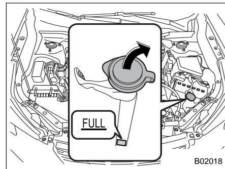
Снимите крышку заправочной горловины бачка для стеклоomyвaющей жидкости, а затем долейте стеклоomyвaющую жидкость до отметки “FULL” на бачке.
