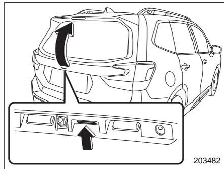
1. Удерживайте кнопку открывания дверцы багажного отсека нажатой (в течение примерно 5 секунд), пока дверца багажного отсека не опустится и не поднимется.
