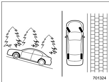
При стоянке на склоне обязательно поворачивайте рулевое колесо. Если при стоянке на склоне Ваш автомобиль обращен вверх, поверните передние колеса от бордюра.
