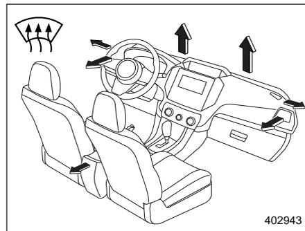
**Обогрев ветрового стекла для типа “А”:** вентиляционные отверстия обогрева ветрового стекла и боковые вентиляционные отверстия в панели приборов с обеих сторон. (См. раздел “Обогрев ветрового стекла” ☞ С. 315).
