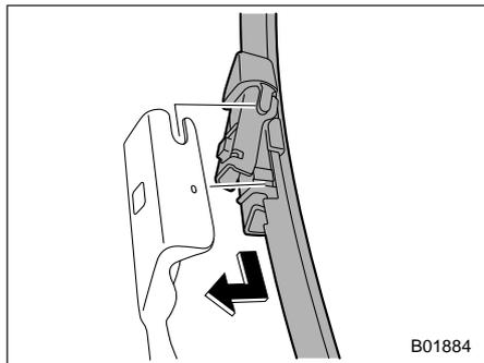
3. При установке щетки стеклоочистителя в сборе совместите ее с соединительной частью рычага стеклоочистителя, а затем сдвиньте для установки в направлении, обратном направлению снятия. После установки щетки стеклоочистителя в сборе убедитесь в том, что соединительная часть полностью зафиксирована.
