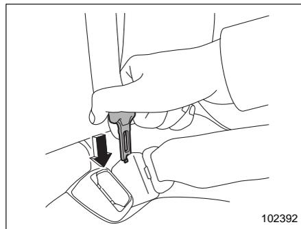
2. Вставьте язычок ремня или другой заостренный предмет из прочного материала в прорезь на правой стороне пряжки соединителя и надавите на него. Язычок соединителя отсоединится от пряжки соединителя.
