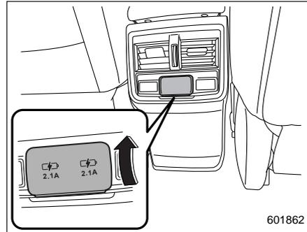
Разъем USB в консоли (только функция электропитания) (если установлен)
