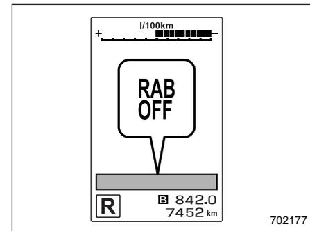
Контрольная лампа отключения системы RAB загорается, если система RAB выключена
