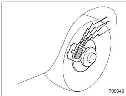
Индикаторы износа колодок на дисковых тормозах обеспечивают подачу предупреждающего шума при определенной степени износа тормозных колодок. Если при торможении в дисковых тормозах слышен визг или скрип, мы рекомендуем Вам немедленно обратиться к Вашему дилеру SUBARU для проведения диагностики.
