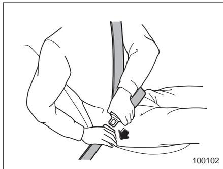
4. Вставьте язычок ремня безопасности в пряжку до щелчка фиксатора.
