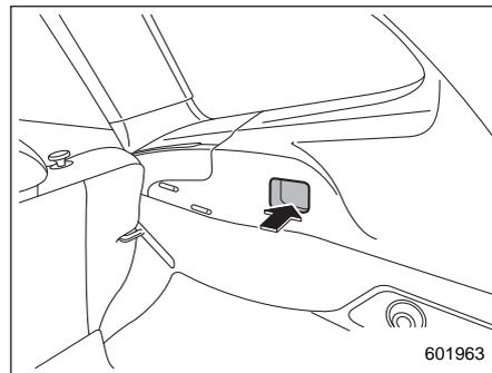
1. Вставьте выступ, расположенный на правом конце кожуха, в паз фиксатора.
