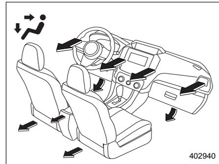
**Двухуровневый обогрев:** вентиляционные отверстия панели приборов и вентиляционные отверстия обдува ног.
