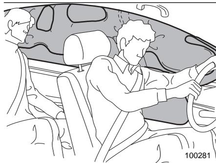
Боковые подушки безопасности водителя и пассажира переднего сиденья и подушки-шторки безопасности имеют отдельные датчики удара, поэтому они срабатывают независимо друг от друга. В связи с этим при аварии они могут сработать не вместе. Кроме того, срабатывание боковых подушек безопасности и подушек-шторок безопасности происходит независимо от срабатывания фронтальных подушек безопасности водителя и пассажира переднего сиденья, расположенных в рулевом колесе и в панели приборов автомобиля.
