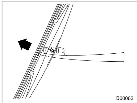
3. Чтобы снять щетку стеклоочистителя с рычага, потяните ее на себя.
