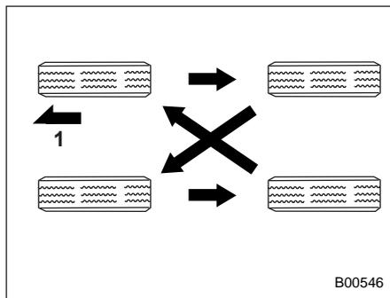
**Модели, оснащенные четырьмя шинами без определения направления вращения**
