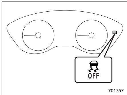
При нажатии или повороте выключателя во время работы двигателя загорается контрольная лампа отключения системы VDC. При этом система VDC отключится, и автомобиль будет вести себя на дороге так же, как автомобиль, не оборудованный такой системой. При повторном нажатии выключателя (тип “А”) или его повороте в сторону “NORMAL” (тип “В”) для включения системы VDC, контрольная лампа выключается.
