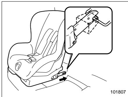
5. Зафиксируйте узлы крепления детского удерживающего устройства за крепежные скобы. Убедитесь в том, что когда узлы крепления зафиксированы, расположенные рядом ремни безопасности не зажаты.
