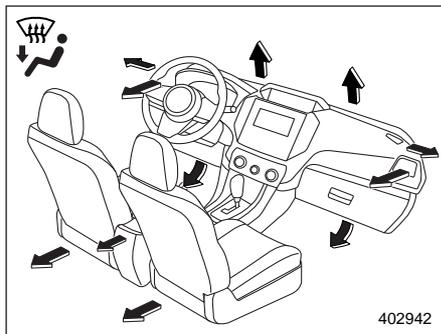
**Обогрев салона/ветрового стекла:** вентиляционные отверстия обогрева ветрового стекла, вентиляционные отверстия обдува ног и боковые вентиляционные отверстия в панели приборов (см. раздел “Обогрев ветрового стекла” ☞ С. 315).
