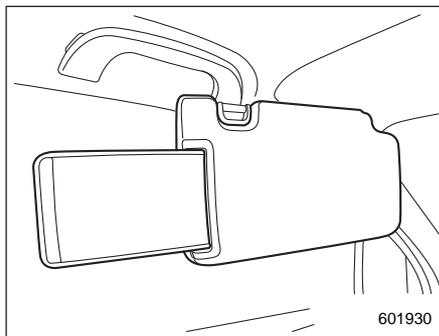
При использовании солнцезащитного козырька над боковым окном выдвижная панель козырька обеспечит Вам защиту от яркого света, закрыв оставшийся зазор между солнцезащитным козырьком и средней стойкой автомобиля. Чтобы использовать выдвижную панель солнцезащитного козырька, вытяните ее в сторону задней части автомобиля. Когда выдвижная панель Вам больше не нужна, уберите ее внутрь козырька, надавив в направлении передней части автомобиля.
