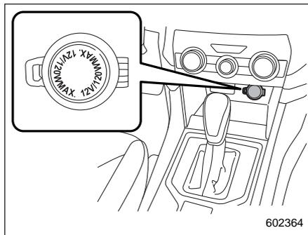
Розетка под панелью управления системой климат-контроля
