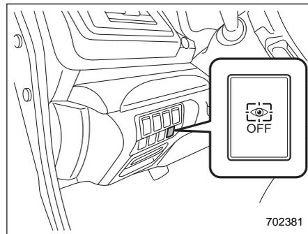
Выключатель системы мониторинга состояния водителя
