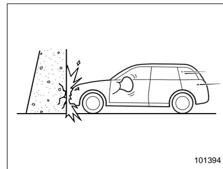
Фронтальные подушки безопасности срабатывают при лобовом столкновении с толстой бетонной стеной при скорости автомобиля 20–30 км/ч или выше. Фронтальные подушки безопасности будут срабатывать и при других лобовых столкновениях, характеризующихся аналогичными количественными и качественными показателями.
