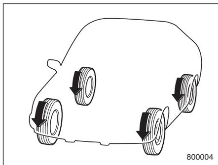
Система полного привода распределяет мощность двигателя на все четыре колеса автомобиля. Полноприводные автомобили обеспечивают лучшее сцепление с дорогой при движении по скользким, мокрым или заснеженным дорогам, а также по грязи, песку или грунту.
