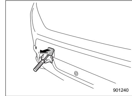
2. Используя отвертку в качестве рычага, снимите с заднего бампера заглушку для получения доступа к резьбовому отверстию, в которое вворачивается буксировочный крюк.
