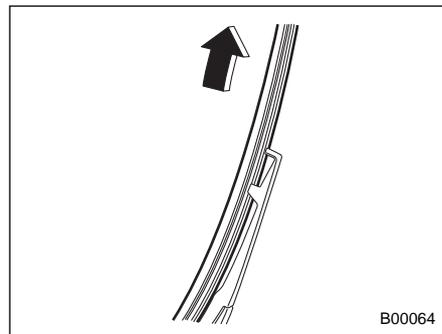
2. Прикладывая усилие, снимите резиновую ленту щетки стеклоочистителя с пластмассового держателя.
