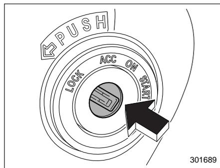
Замок зажигания имеет четыре положения: “LOCK”, “ACC”, “ON” и “START”.
