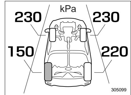
На данном экране отображается давление воздуха в каждой шине. См. раздел "Основные экраны" ☞ С. 228.
