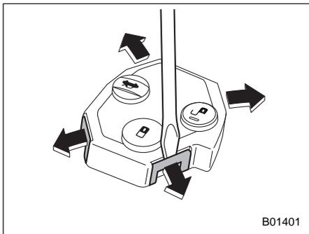
3. Откройте корпус передатчика, отсоединив крючки.
