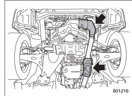
Каталитический нейтрализатор устанавливается в системе выпуска. Он обеспечивает дожигание отработавших газов, тем самым уменьшая содержание в них углеводородов, окиси углерода и оксидов азота, осуществляя таким образом очистку отработавших газов двигателя.
