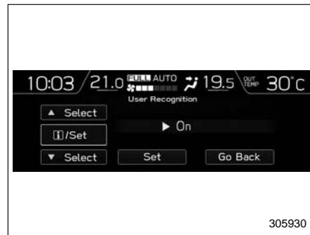
2. При помощи клавиш управления выберите вариант “Включено” или “Выключено”, чтобы включить или выключить распознавание пользователя.
