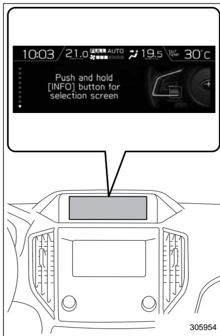
3. Во время отображения экрана инструкций нажмите и удерживайте кнопку "INFO" на рулевом колесе. Экран переключится на экран настроек.
