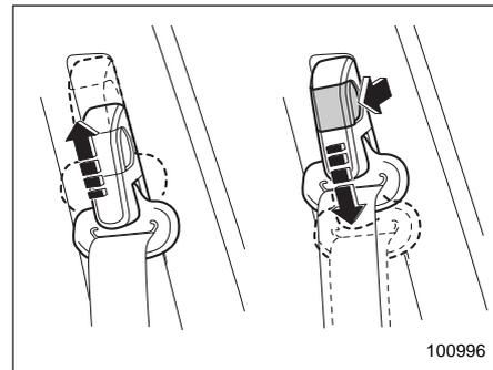
Положение верхнего узла крепления плечевой лямки ремня безопасности должно регулироваться в соответствии с ростом водителя или пассажира переднего сиденья. Положение верхнего узла крепления плечевой лямки ремня безопасности должно быть отрегулировано таким образом, чтобы лямка проходила через середину плеча и не касалась шеи.
