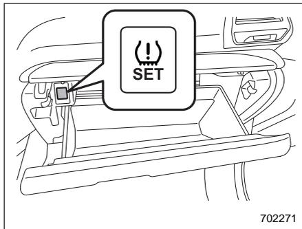
1. Когда на комбинации приборов отображается счетчик пройденного пути, нажмите и удерживайте переключатель установки режима системы TPMS (примерно на 3 секунды). На дисплее счетчика пройденного пути отображается текущий режим системы TPMS, и его можно изменить.
