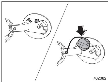
6. Вставьте крышку топливозаправочной горловины в держатель, расположенный с внутренней стороны лючка топливозаправочной горловины.
