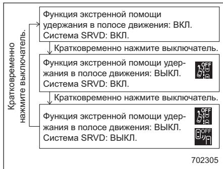
Кратковременно нажмите выключатель системы SRVD для отключения функции экстренной помощи удержания в полосе движения.
