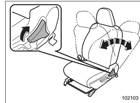
Потяните рычаг, фиксирующий угол наклона спинки сиденья, вверх и установите спинку в удобное для Вас положение. Затем отпустите рычаг и убедитесь в том, что положение спинки надежно зафиксировано.
