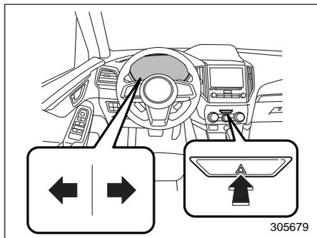
Аварийная световая сигнализация предназначена для извещения других водителей о том, что Вы вынуждены были сделать остановку в связи с возникновением экстренной ситуации. Аварийная световая сигнализация может быть включена при любом положении замка зажигания.
