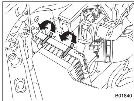
1. Отстегните два зажима, удерживающие переднюю часть корпуса воздушного фильтра.
