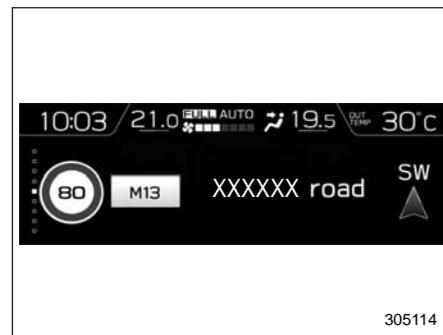
На экране отображается информация о пункте назначения системы навигации.
