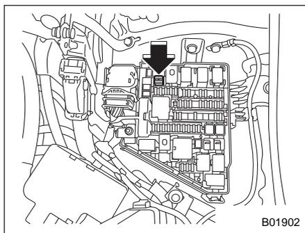
Пинцет для предохранителей хранится в главном блоке предохранителей, расположенном в моторном отсеке. Зажмите верхнюю часть предохранителя пинцетом, а затем извлеките его из главного блока предохранителей.
