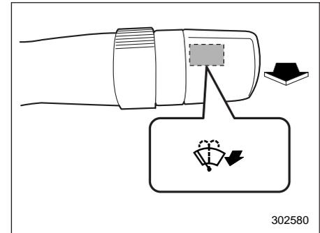
Для включения омывателя ветрового стекла потяните рычаг управления стеклоочистителями на себя. Разбрызгивание жидкости будет происходить до тех пор, пока Вы не отпустите рычаг. Пока Вы тянете рычаг, будет работать стеклоочиститель.
