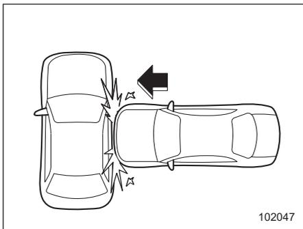
Боковая подушка безопасности и подушка-шторка безопасности срабатывают при сильном боковом ударе в область одного из передних сидений.
