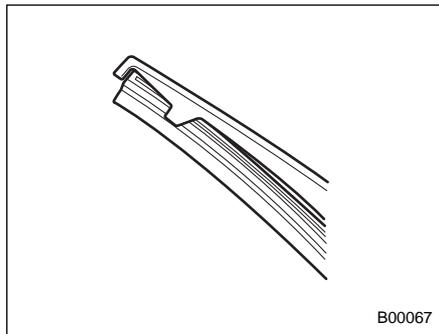
Надежно зафиксируйте оба конца резиновой ленты при помощи фиксаторов, расположенных на концах пластмассового держателя. Если надежная фиксация резиновой ленты не обеспечена, щетка стеклоочистителя может поцарапать заднее стекло.
