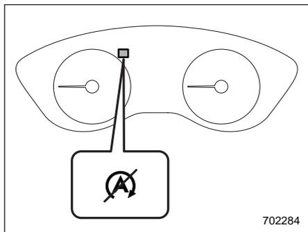
Контрольная лампа невыполнения условий для срабатывания системы автоматического запуска/остановки двигателя (тип "А")
