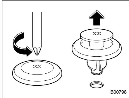
1. При помощи крестообразной отвертки поверните фиксатор против часовой стрелки до тех пор, пока не поднимется центральная часть фиксатора.
