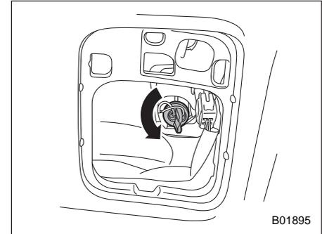
2. Поверните патрон лампы против часовой стрелки и извлеките его.
