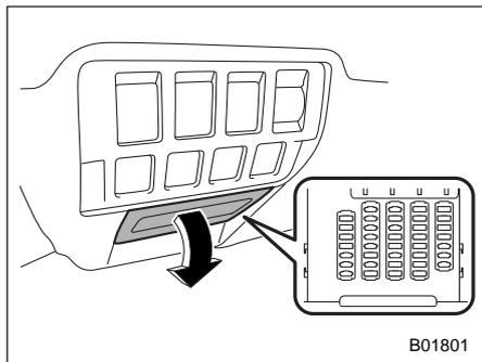
Один из них расположен за крышкой под панелью приборов со стороны водителя. Чтобы снять крышку, потяните ее на себя.
