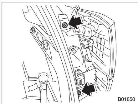
5. При помощи крестообразной отвертки отверните винты, крепящие задний комбинированный фонарь.
