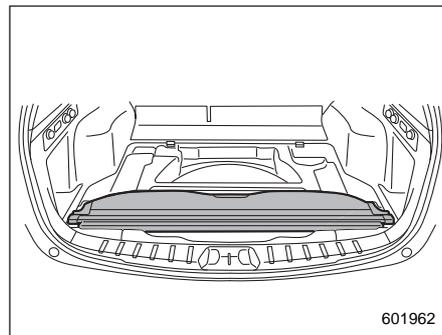
3. Положите кожух выдвижной шторки у заднего края багажного отсека.
