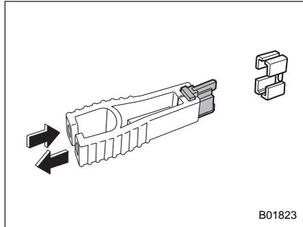
4. Извлеките предохранитель с помощью специального пинцета для предохранителей.
