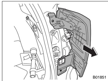
6. Сдвиньте задний комбинированный фонарь назад и снимите его с автомобиля.
