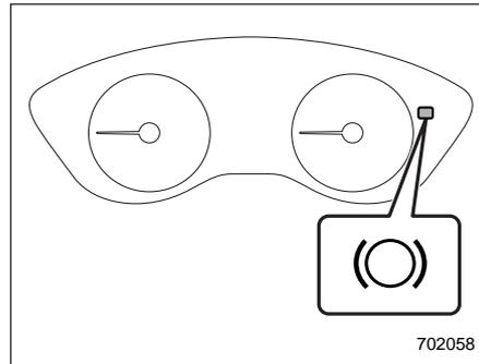
Контрольная лампа срабатывания функции автоматического удержания автомобиля
