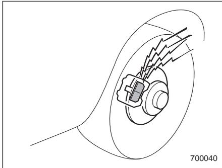
Дисковые тормоза снабжены звуковыми индикаторами износа тормозных колодок. Когда степень износа тормозных колодок приближается к нормативному пределу, то при нажатии педали тормоза индикатор износа издает очень громкий скрежет.
