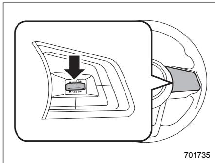
Нажмите на сторону “SET” переключателя “RES/SET” и удерживайте ее нажатой до достижения автомобилем требуемой скорости. Затем отпустите переключатель. При этом скорость, с которой в этот момент движется Ваш автомобиль, будет сохранена в памяти и она будет восприниматься системой
