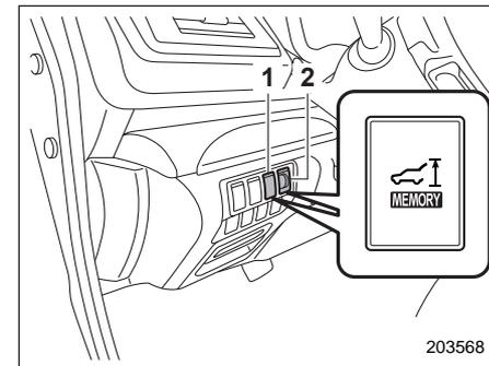
Кнопка регистрации высоты подъема дверцы багажного отсека
