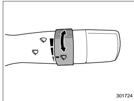
Когда переключатель стеклоочистителя находится в положении “☞”, то установка требуемого временного интервала обеспечивается поворотом кольца. Может быть установлен один из нескольких временных интервалов: от самого короткого до самого длинного.
