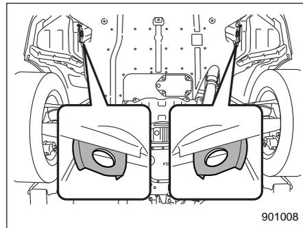
Передние крепежные крюки расположены между каждым из передних колес и передним бампером.
