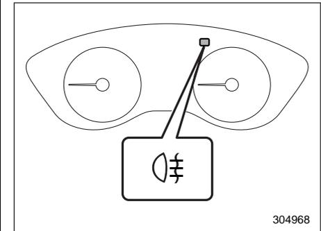
При включении заднего противотуманного фонаря на комбинации приборов загорается контрольная лампа.
