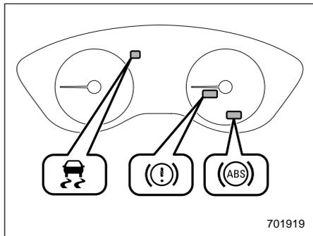
При появлении какой-либо неисправности в системе EBD она перестает работать и одновременно загораются следующие предупреждающие лампы.
