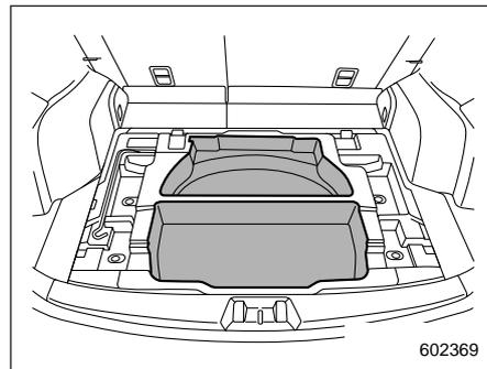
Отделение для хранения и перевозки вещей, расположенное под полом багажного отсека, может использоваться для хранения небольших предметов. Потяните за ремешок, чтобы открыть центральную часть крышки пола багажного отсека, а затем снимите крышку.
