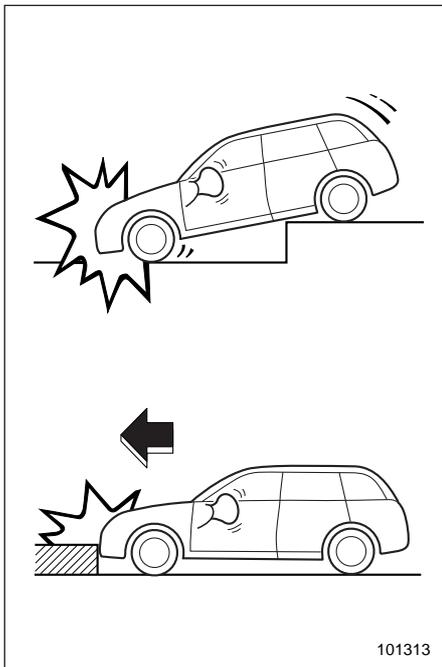
Фронтальные подушки безопасности могут сработать при сильных ударах о поверхность дорожного покрытия, вос-
