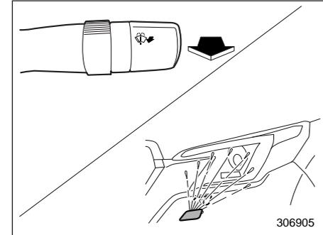
Если при установленном в положение “ON” выключателе зажигания Вы потянете рычаг управления стеклоочистителем на себя и будете его удерживать более 1 секунды, то при выполнении следующих условий вместе с омывателем ветрового стекла сработают омыватели фар.
