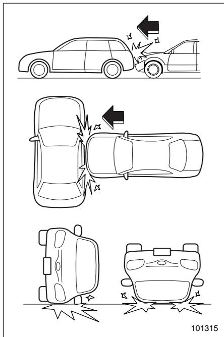
Конструкция фронтальных подушек безопасности не предусматривает их срабатывания в большинстве случаев при
