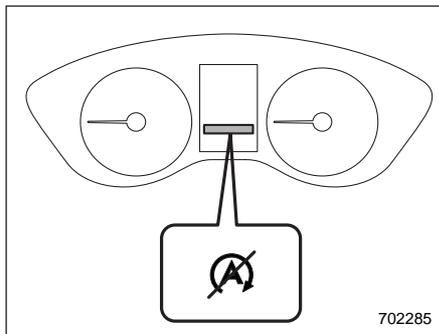
Контрольная лампа невыполнения условий для срабатывания системы автоматического запуска/остановки двигателя (тип "В")
