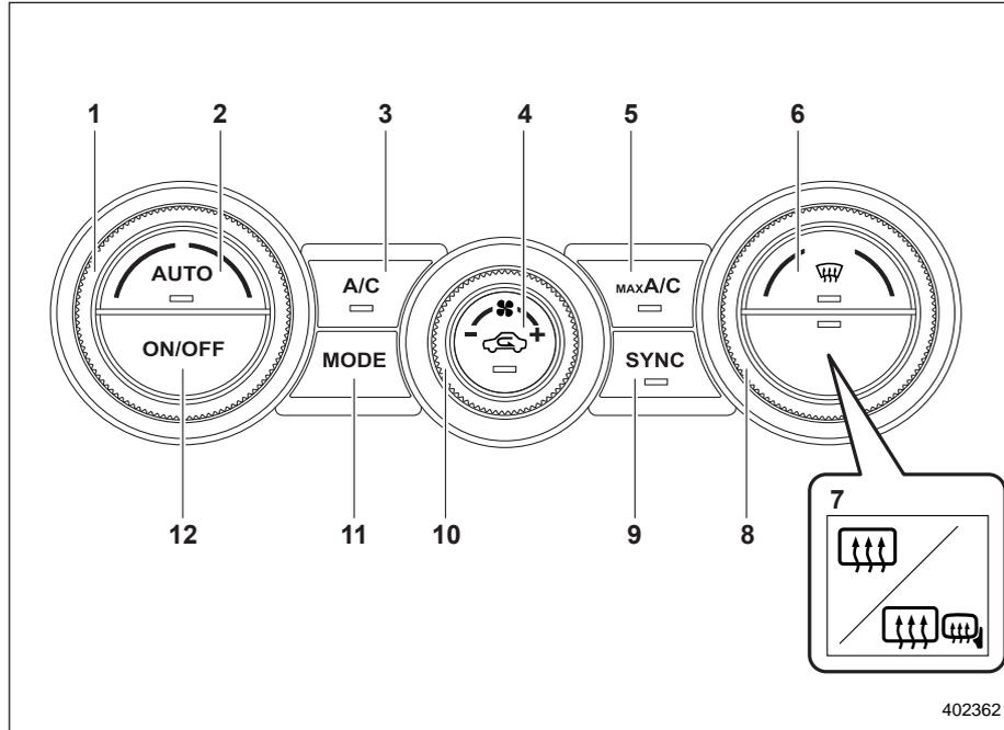
1) Ручка регулировки температуры (левая сторона) (см. раздел “Автоматический режим работы системы климат-контроля” ☞ С. 308 и/или “Регулировка температуры” ☞ С. 313).
