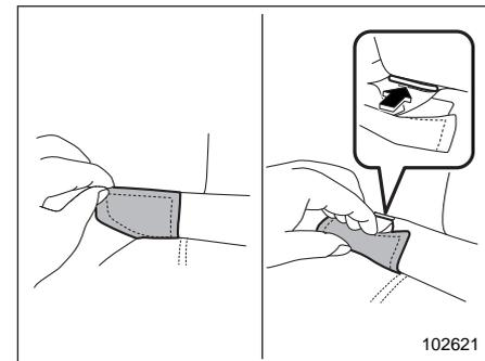
1. Отделите чехол крепления с выбранной стороны спинки заднего сиденья. Вы можете согнуть отделенный чехол крепления пополам и закрепить его крючком и лентой, чтобы открыть крепления (скобы) для их использования при установке детского удерживающего устройства.
