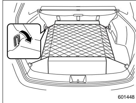
В багажном отсеке Вашего автомобиля предусмотрены несколько крючков для крепления фиксирующей сетки или веревок, предназначенные для фиксации перевозимых грузов.
