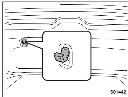
Вспомогательный крючок закреплен на внутренней отделке дверцы багажного отсека. При открытой дверце багажного отсека Вы можете повесить на крючок фонарь, мокрую одежду и т. п.
