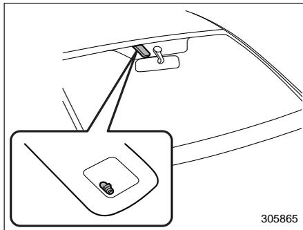
Датчик дождя/освещенности расположен на ветровом стекле.
