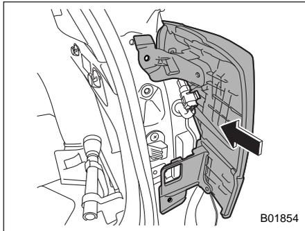
11. Установите задний комбинированный фонарь на место, совмещая 2 штифта с отверстиями, и закрепите на автомобиле.
