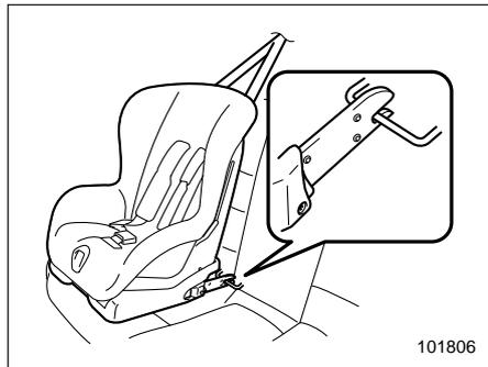
На Вашем автомобиле установлены крепежные скобы ISOFIX, которые предназначены для установки на заднем сиденье рекомендованных к применению детских удерживающих устройств системы ISOFIX без использования ремня безопасности.
