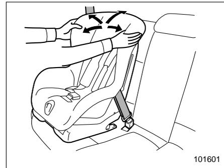
9. Перед тем как посадить ребенка в детское удерживающее устройство, проверьте надежность его фиксации, попробовав подвигать устройство вперед/назад и из стороны в сторону. Иногда можно обеспечить более прочную фиксацию детского удерживающего устройства, прижимая его к подушке сиденья и подтягивая ремень безопасности.
