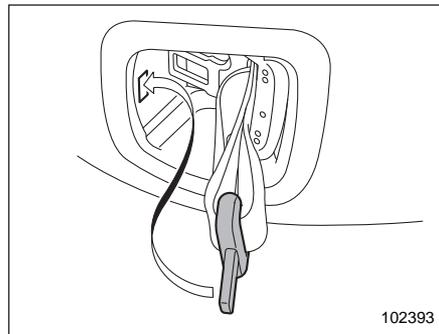
3. Дайте натяжителю втянуть ремень. Обеспечьте правильное положение ремня безопасности, направляя его при втягивании в натяжитель. Аккуратно поместите язычок ремня безопасности в углубление, а затем вставьте язычок соединителя в прорезь.
