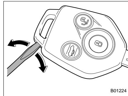
1. Оберните плоскую отвертку виниловой лентой или тканью. Откройте головку ключа при помощи плоской отвертки.
