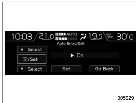
2. При помощи клавиш управления выберите вариант “Включено” или “Выключено”, чтобы включить или выключить функцию автоматической посадки/высадки.
