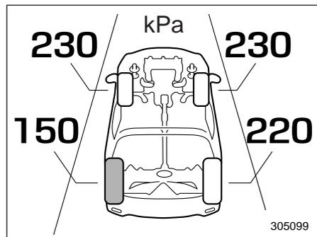
На данном экране отображается давление воздуха в каждой шине. Если шина спущена, то эта шина и давление воздуха в ней отображаются на экране желтым цветом.
