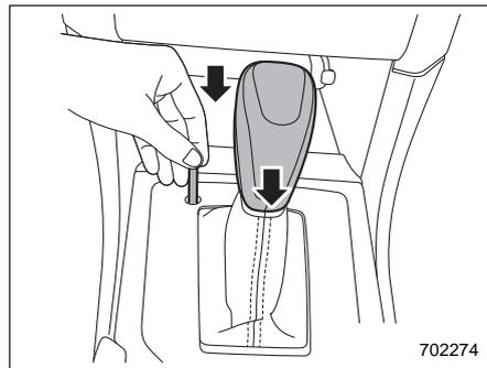
3. Выжав педаль тормоза, вставьте в отверстие отвертку, нажмите ей на кнопку разблокировки рычага селектора, а затем переместите рычаг селектора.
