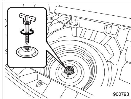
6. Извлеките контейнер для инструментов и поверните крепежный болт против часовой стрелки, а затем извлеките запасное колесо.
