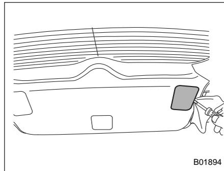
1. Подденьте крышку фонаря, используя прямую отвертку в качестве рычага, как показано на приведенном выше рисунке, и снимите крышку с отделки дверцы багажного отсека.
