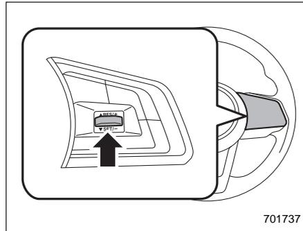
Нажмите на сторону "RES" переключателя "RES/SET" и удерживайте ее нажатой до достижения автомобилем требуемой скорости. Затем отпустите переключатель. При этом скорость, с которой в этот момент движется Ваш автомобиль, будет сохранена в памяти и она будет восприниматься системой круиз-контроля в качестве новой установленной скорости движения.
